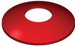
**Elásticas** Las arandelas elásticas, también conocidas como de resorte, presentan irregularidades que se comprimen con una resistencia proporcional para volver a su forma predefinida. Las arandelas elásticas se emplean cuando se necesita una pieza que recoja la holgura, mantenga la tensión del conjunto, compense la expansión o contracción de los materiales o absorba cargas de choque intermitentes y proporcione una reacción controlada bajo cargas dinámicas.
