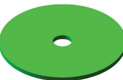
**Guardabarros** Las arandelas guardabarros tienen un gran diámetro exterior en comparación con el interior. El nombre de "Fender" (guardabarros) proviene de su uso en la industria del automóvil, donde se utilizan para montar guardabarros. Las arandelas de guardabarros distribuyen la carga uniformemente en una gran superficie. Las arandelas planas cuyo diámetro exterior mide más de tres veces el diámetro interior se denominan comúnmente arandelas guardabarros.
