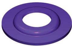
**De hombro** Las arandelas de hombro, también conocidas como arandelas "Step" o "Flange", tienen una apariencia de sombrero de copa baja y un manguito cilíndrico integral. El manguito está diseñado para acoplarse a un recorte y separa el elemento de fijación del material al que se fija. Estas arandelas se utilizan principalmente en la industria de equipos electrónicos como aislantes y están hechas de materiales no conductores.
